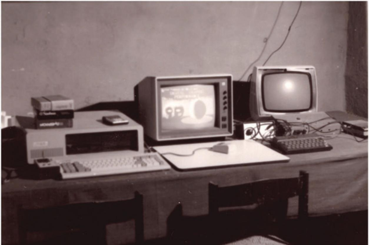
Fabrizio Savi, angolo laboratorio durante la sperimentazione e la realizzazione dell'opera HALLEY, personal computer IBM compatibile con processore INTEL 8086 16 bit con scheda grafica a tre colori, l'allora innovativo mouse, joystick potenziometrico, scheda convertitore analogico digitale, 1985
